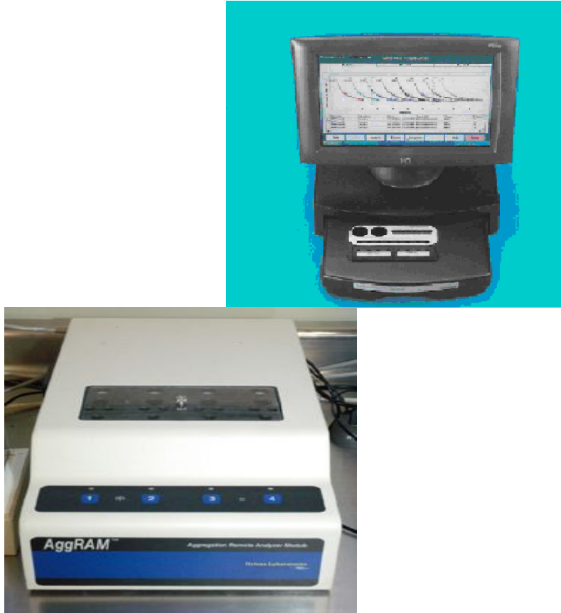
Şekil 4: Sekiz kanallı ve dört kanallı Optik Agregometri (Light Transmittance Agregometry-LTA) (Pakala R. Currently available methods for platelet function analysis: advantages and disadvantages. Cardiovascular Revascularization Medicine, Volume 12, Issue 5, Pages 312-322'den alınmıştır)
